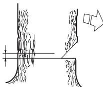
Вставьте зубчатый упор (если установлен) сзади надреза. Работайте на полном газу и вводите пильное полотно в ствол дерева постепенно, плавным движением. Следите за тем, чтобы дерево не начало перемещаться в направлении, противоположном предполагаемому направлению падения. Как
