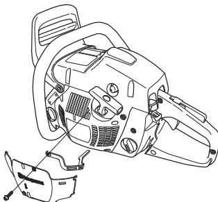
Обратите внимание! Если для повышения рабочей температуры двигателя применяются специальные приспособления для работы в зимних условиях, необходимо заново отрегулировать все характеристики машины, установленные для работы в нормальных условиях. В противном случае может произойти перегрев двигателя, что приведет к его серьезным повреждениям.
