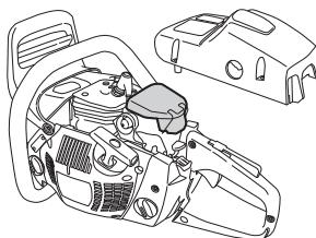
Для более тщательной чистки фильтр следует помыть в воде с мылом.
