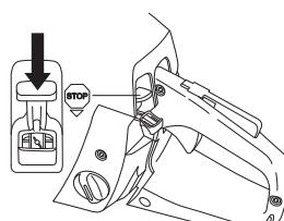
Двигатель останавливается путем выключения зажигания.
