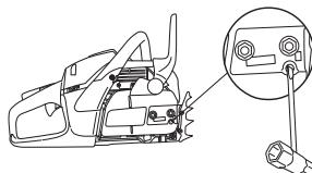
Цепь считается натянутой правильно, если она свободно проворачивается рукой. После этого , удерживая носок пильного полотна в верхнем положений, затяните гайки крепления пильного полотна универсальным ключом.
