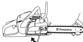
При установке новой цепи следует часто проверять ее натяжение , пока цепь не приработается. Регулярно проверяйте натяжение цепи. Регулярно проверяйте натяжение цепи. Правильно натянутая цепь обеспечивает высокое качество пиления и дольше служит.
