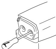
В некоторых глушителях предусмотрен специальный искрогаситель. Если ваша машина оборудована таким глушителем, сетку фильтра следует чистить раз в неделю. Наилучше пользоваться стальной щеткой. Забитая решетка приводит к работе с горячим двигателем, что дает серьезные повреждения двигателя.
