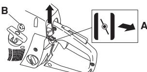
Декомпрессионный клапан (C): Его необходимо нажать, чтобы уменьшить давление в цилиндре и облегчить запуск машины. При запуске машины всегда пользуйтесь декомпрессионным клапаном. После запуска машины он
