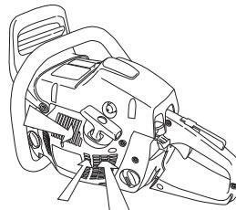
**ВАЖНО!** Для осуществления метода центробежной очистки нужно постоянно выполнять техническое обслуживание и уход за системой. Необходимо чистить воздухозаборник стартера, лопасти вентилятора на маховике, пространство вокруг маховика, входного коллектора и карбюратора.
