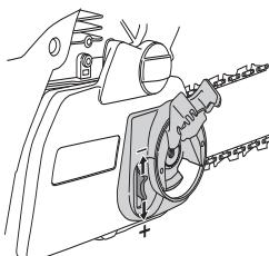
Цепь натянута правильно, если она не провисает под направляющей, но ее можно свободно провернуть вручную. Придерживая носовую часть направляющей, затяните ее
