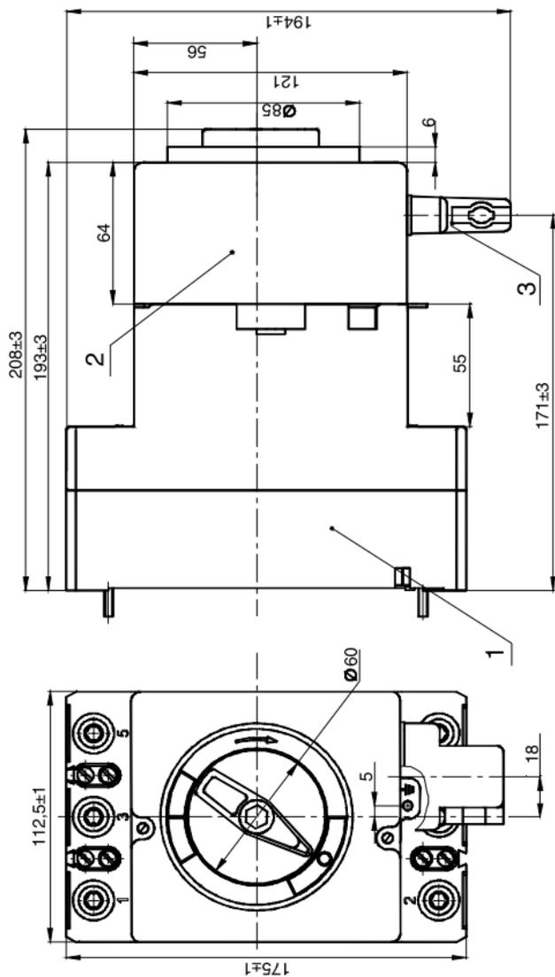
1 - выключатель; 2 - привод электромагнитный; 3 - соединитель типа РП10.
