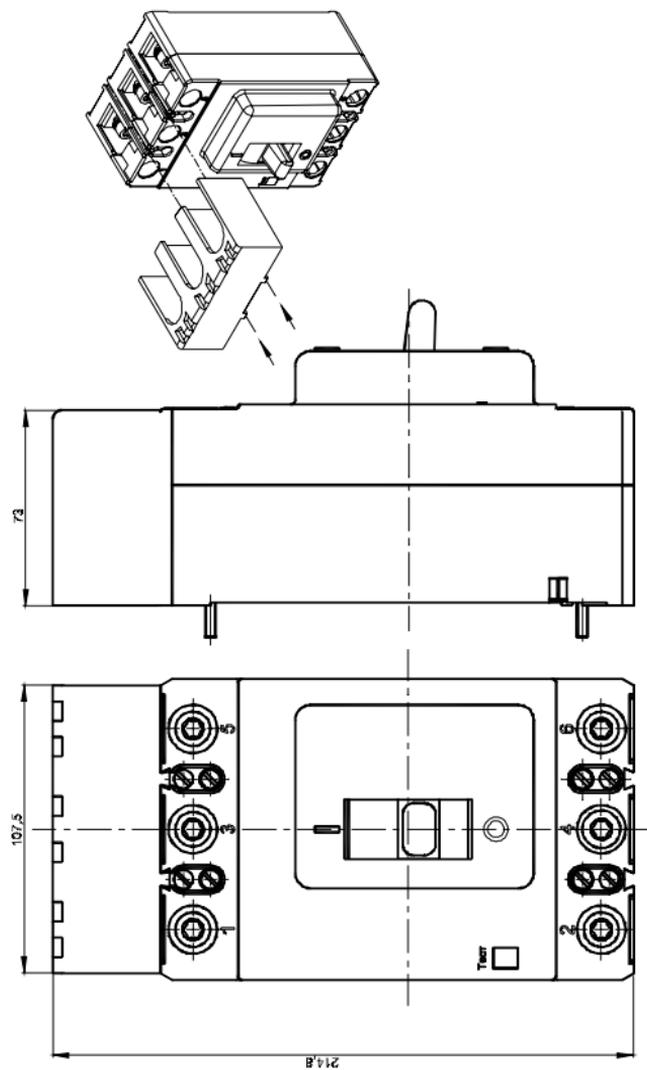
Автоматические выключатели с ручным дистанционным приводом для оперирования через дверь распределительного устройства
