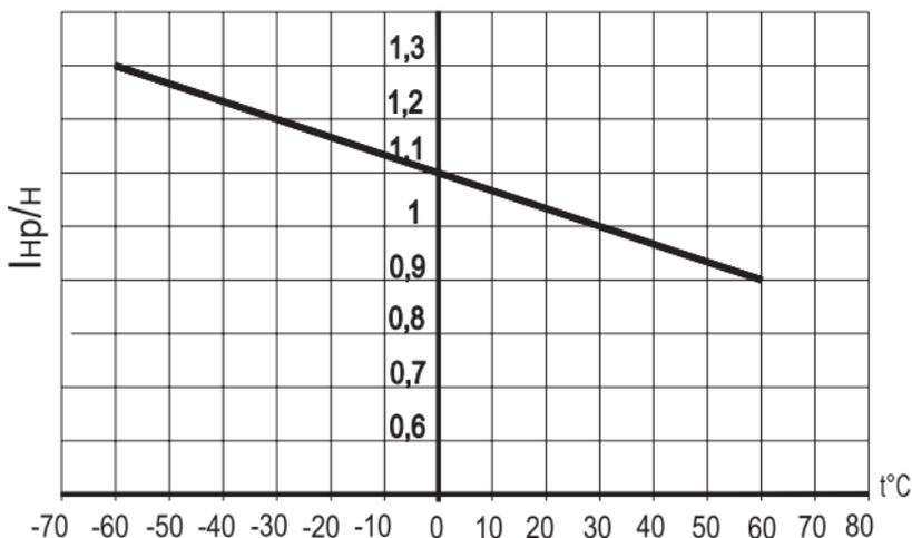
**Рисунок 1.** Зависимость номинального рабочего тока выключателей от температуры окружающего воздуха
