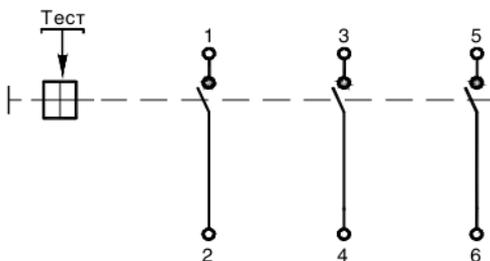
Схема электрическая принципиальная выключателя со вспомогательными контактами
