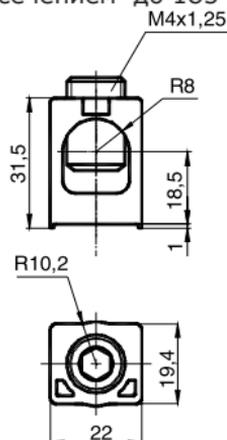
Двугнездный зажим для присоединения двух кабелей сечением до 95 мм<sup>2</sup>
