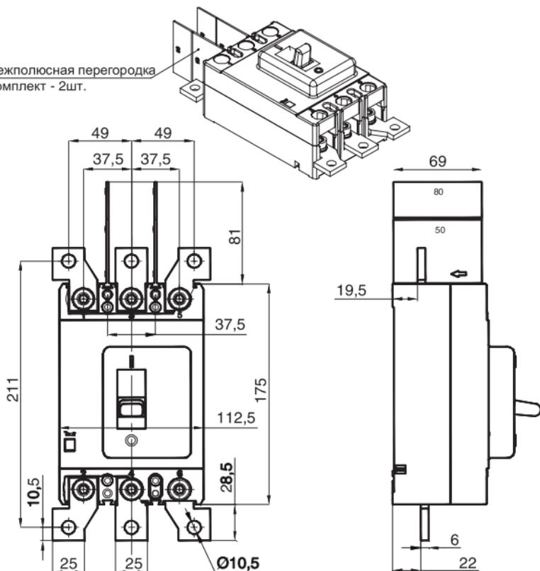
Присоединение с дополнительными расширительными выводами и межполюсными перегородками
