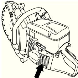
**ПРЕДУПРЕЖДЕНИЕ!** Загрязненный или закрытый воздухозаборник может привести к перегреву машины и вызвать повреждение поршня и цилиндра.
