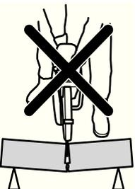
Если диск зажатым или застрянет в зоне отдачи, сила реакции будет толкать устройство вверх и назад к оператору вращательным движением, что может вызвать опасную или даже смертельную травму.
