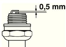
**ПРЕДУПРЕЖДЕНИЕ!** Всегда используйте только указанный тип свечи! Применение несоответствующей модели может привести к серьезным повреждениям поршня/цилиндра.
