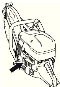
**ПРЕДУПРЕЖДЕНИЕ!** Загрязненный или закрытый воздухозаборник может привести к перегреву машины и вызвать повреждение поршня и цилиндра.
