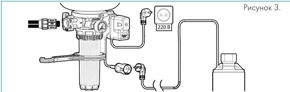
8. После монтажа и сборки всех элементов системы необходимо при первом пуске насоса убедиться в герметичности всех соединений; течь воды не допускается. Система готова к работе.
