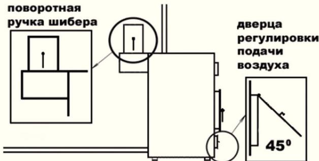
3. - откройте заслонку в дымоотводящем патрубке полностью для обеспечения максимальной тяги (если шибер шторный – то выдвинуть его полностью);
