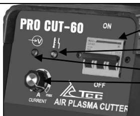
1. Сетевой выключатель. Включение / выключение электропитания.
