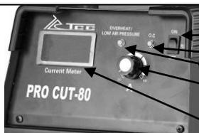
1. Кнопка включения режима пилотной дуги
