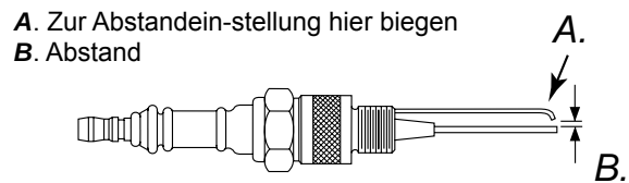
Abbildung 15 – Elektrodenabstand 20, 29, 44 kW Modelle.
