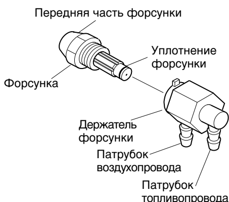
Рис. 22. Форсунка и держатель форсунки, нагреватель мощностью 10 кВт
