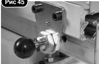
Ручка фиксации положения подвижного стола, установлена в крайнем положении
