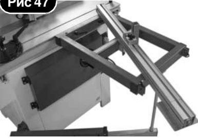
Упор рамы удлинения стола, установленный под углом 45^\circ
