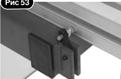
Ограничитель удлинения стола под углом 90^\circ
