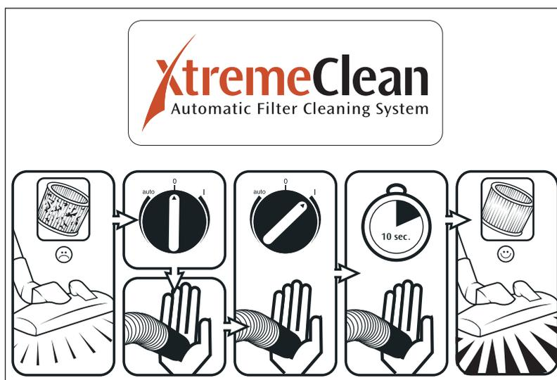
Для обеспечения постоянной высокой мощности всасывания проводится автоматическая очистка фильтрующего элемента во время работы. В случае очень сильного загрязнения рекомендуется провести полную очистку.
