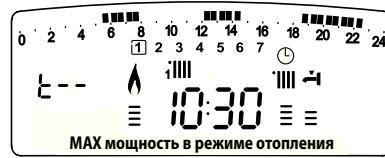
Для включения режима ГВС при максимальной мощности поверните ручку - регулятор. При этом на дисплее отобразится следующее:
