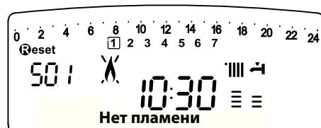
В коде неисправности (например, 101) первая цифра указывает, в каком узле произошло нарушение нормальной работы.
