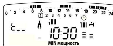
Режим “Трубочист” отключается автоматически через 10 мин или при нажатии кнопки Esc (отмена).
