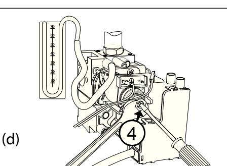
«t\_» Отсоедините провод от регулятора давления (модулятора). Давление газа на входе должно соответствовать указанному для данного типа газа в сводной таблице параметров в зависимости от типа газа. В противном случае отрегулируйте его винтом «4» (рис. d).
