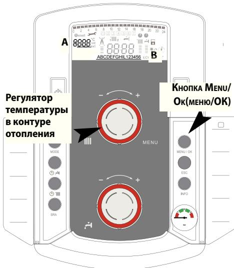
Доступ к различным меню, подменю и параметрам возможен посредством клавиши MENU/OK и кодирующего устройства 3.
