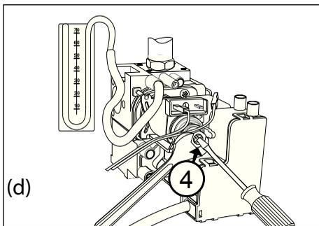
работал на минимальной мощности, нажмите кнопку  $\ominus$ . На дисплее высвечивается «t». Отсоедините провод от регулятора давления (модулятора). Давление газа на входе должно соответствовать указанному для данного типа газа в сводной таблице параметров в зависимости от типа газа. В противном случае отрегулируйте его винтом «4» (рис. d).
