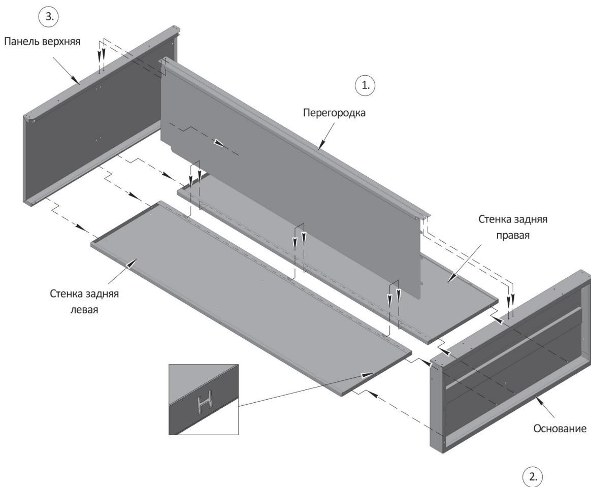
1. Разместите левую и правую задние стенки профильными частями к середине, как показано на рисунке, на торцевой стороне каждой стенки имеется буква «Н» обозначающая нижнюю часть. Между ними установите перегородку, так чтобы 3 язычка были направлены в нижнюю часть стенок, и соедините элементы через совпадающие отверстия (обозначены пунктиром) при помощи 3-х винтов M6x13мм. шайб и гаек М6, но не затягивая их.
