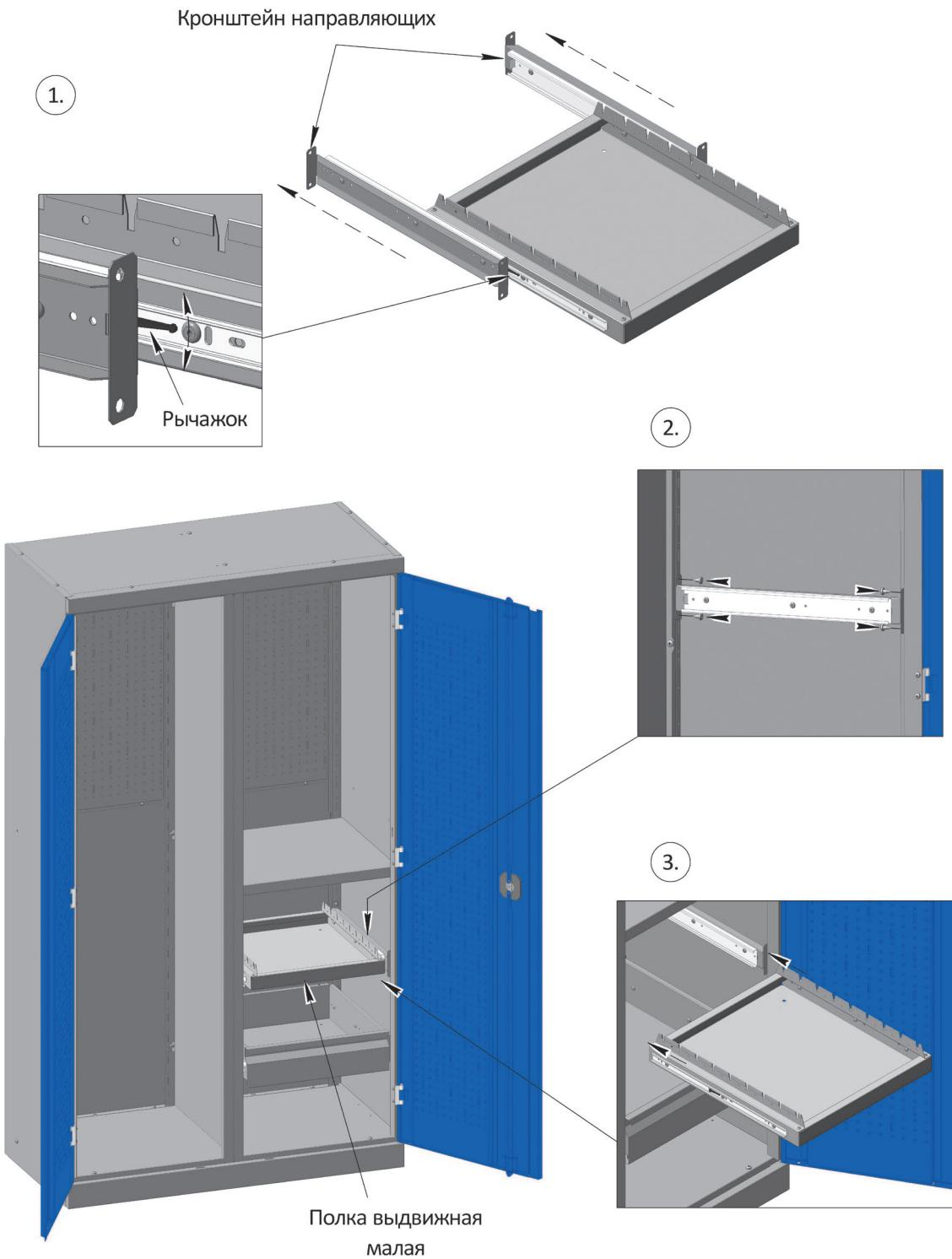
1. Перед установкой ящика выдвижного в корпус шкафа или антресоли, необходимо снять кронштейны направляющих. Для этого нужно выдвинуть кронштейны назад до упора, у направляющих отогнуть рычажок (показано на сноске), вверх или вниз, затем продолжить выдвижение кронштейна до полного снятия с ящика.
