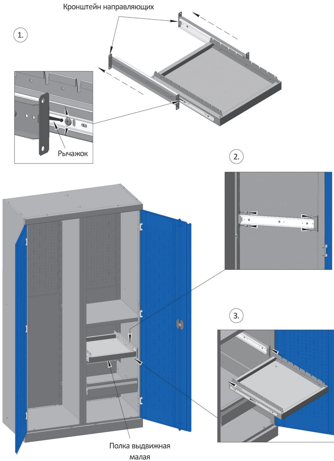
1. Перед установкой полки выдвижной в корпус шкафа или антресоли, необходимо снять кронштейны направляющих. Для этого нужно выдвинуть кронштейны назад до упора, у направляющих отогнуть рычажок (показано на сноска), вверх или вниз, затем продолжить выдвижение кронштейна до полного снятия с полки. Установка кронштейнов направляющих и полок осуществляется так же, как и установка ящиков.
