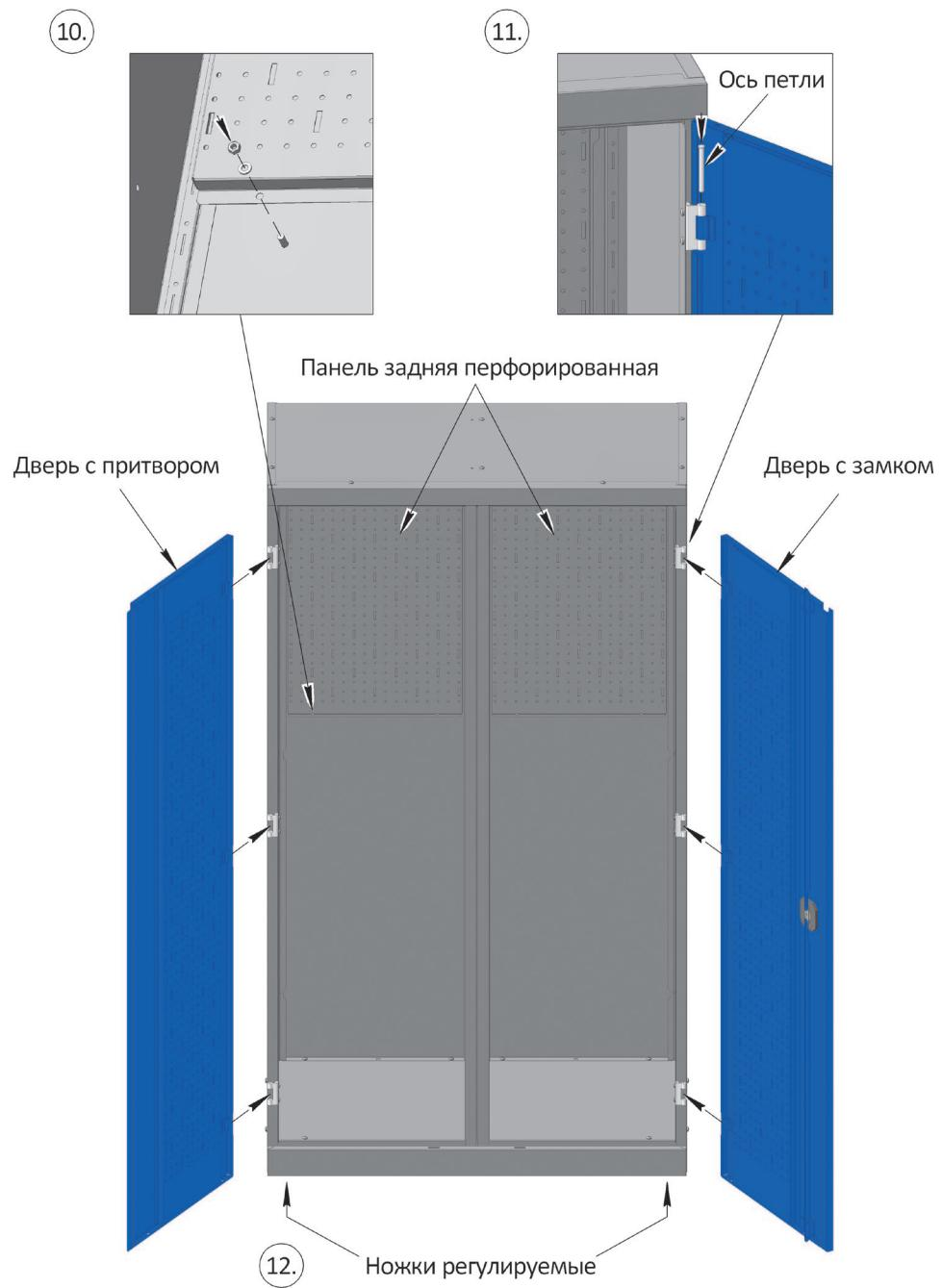
10. Установите корпус в вертикальное положение. Разместите внутри шкафа или антресоли, сверху на задних стенках, панели задние перфорированные. Совпадая отверстия на элементах закрепите панели при помощи 8-и винтов М6х13мм. шайб и гаек М6.
