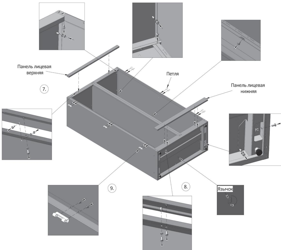
7. Установите панель лицевую верхнюю как указывают линии на рисунке, совместив резьбовые втулки, установленные на внутренней части панели лицевой, с отверстиями на передней части панели верхней, закрепите её при помощи 2-х винтов М6х13мм. и шайб. Далее через отверстия в верхней части закрепите панель лицевую к панели верхней при помощи 2-х винтов М6х13мм. шайб и гаек М6, показано на сноске.
