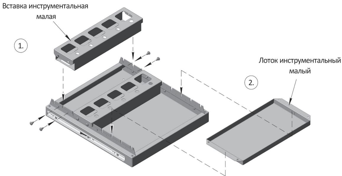
1. Установите вставку инструментальную в пазы полки, закрепите при помощи 4-х самонарезающих винтов 6,3x13мм., как показано на рисунке. Винты идут в комплекте с вставкой.
