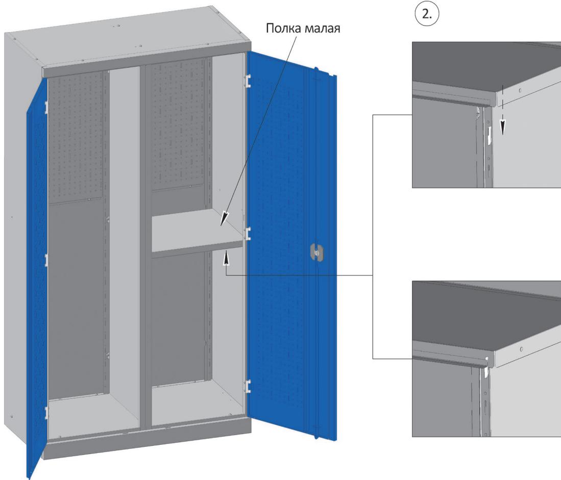
1. Определите, в каком месте будет установлена полка (полки). Возьмите из комплекта 4 скобы полки, установите их в вертикальные пазы, которые расположены в профильных частях углов шкафа (перегородки), установка скобы показана на схеме. В нижней части скобы имеется малый паз, смещённый к краю, ориентируйте скобу так, чтобы паз был направлен внутрь профильной части.
