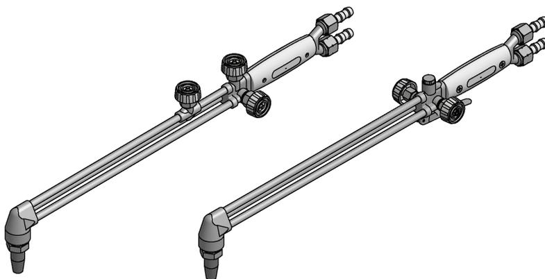
Резак состоит из головки, вентиля горючего газа (ГГ), подогревающего кислорода (КП), режущего кислорода (КР) (или клапана с рычагом), ручки и присоединительного блока с гайками и ниппелями. Все элементы резака соединены между собой трубками (соединение неразборное).
