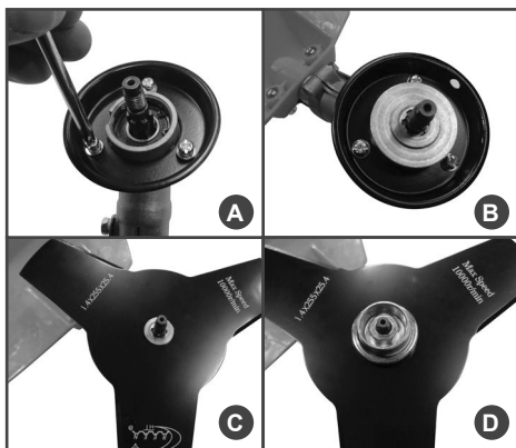
Рис.5 Установка ножа для травы
