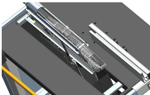
3. Одной рукой снять прижимной фланец (съемный фланец), а другой рукой поддерживать защитный кожух.
