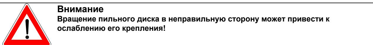
Если при подключении станка электродвигатель вращается в неправильную сторону, необходимо поменять полярность проводов (переключить фазы)
