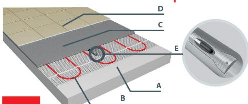
Типичная конструкция пола:
