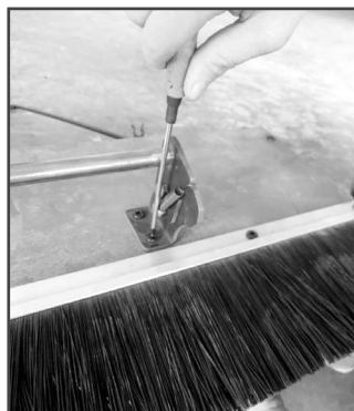
Рис. 2 Установка крепежной планки
