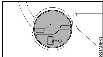
Винтовое запорное устройство бака
