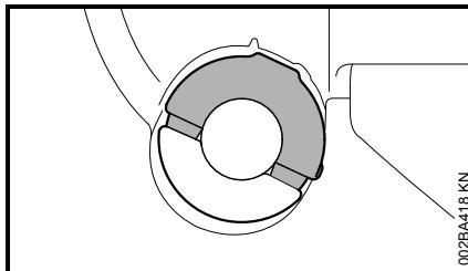
Запорное устройство бака с откидным хомутиком (байонетный затвор)
