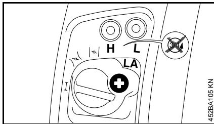
Данные агрегаты отрегулированы на заводе таким образом, чтобы при любых условиях окружающей среды и любых рабочих состояниях подавалась оптимальная топливовоздушная смесь.
