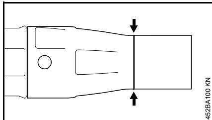
Во время работы передняя часть насадки из-за скользящего контакта с землёй изнашивается. Насадка является изнашиваемой деталью и при достижении маркировки износа должна заменяться.
