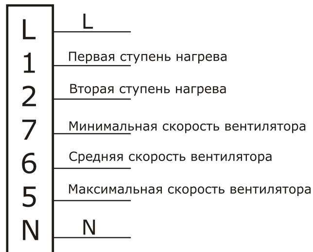
Рис. 4. Электрическая схема подключения пульта управления
