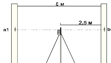
Повторите измерения на расстоянии примерно 0.6 м от одной стены и на расстоянии примерно 4.4 м от другой. Отклонение между первым замером (с одинаковыми расстояниями до точек замера), и вторым замером (с расстоянием 0.6м и 4.4м) не должно превышать 2мм.
