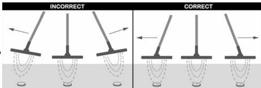
Чтобы не копать большие ямы, необходимо точно определить местонахождение объекта. Услышав сигнал, пройдите катушкой вдоль предполагаемой цели, водя металлоискателем по воображаемой линии. Затем, повернитесь лицом на 90 градусов от начального направления и повторите процесс. Цель расположена там, где две воображаемых линии пересекаются.
