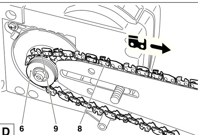
Пильную шину надо слегка прижать левой рукой к креплению на корпусе и провести пильную цепь (9) через направляющую звездочку (10) пильной шины, слегка натягивая при этом пильную цепь в направлении стрелки.
