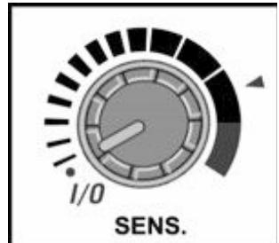
*XP Adventis 2* имеет усовершенствованную систему настройки чувствительности по сравнению со своим предшественником, позволяющую более точно настраивать прибор, во избежание ложных срабатываний. Благодаря этим усовершенствованиям, верхний порог чувствительности был увеличен.
