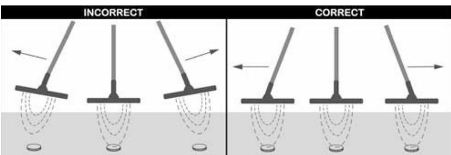
Чтобы не копать большие ямы, необходимо точно определить местонахождение объекта. Услышав сигнал, пройдите катушкой вдоль предполагаемой цели, водя металлоискателем по воображаемой линии. Затем, повернитесь лицом на 90 градусов от начального направления и повторите процесс. Цель расположена там, где две воображаемых линии пересекаются.
