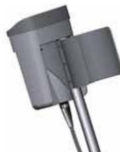
Чтобы снять блок управления (1), установите руки, как показано на рисунке, затем нажмите большими пальцами на подлокотник и двигайте его на себя.
