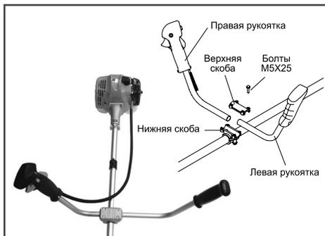
Рис.4 Установка рукояток
