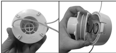
Зафиксируйте концы корда в специальных пазах на катушке. Проденьте концы корда в отверстия на корпусе триммерной головки и установите катушку с кордом в корпус головки.
