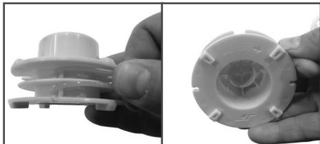
Намотайте корд плотно с натягом в канавку катушки. Направление намотки указано стрелкой (**WIND CORD** →)
