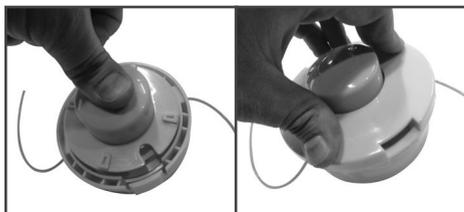
Установите крышку головки и зафиксируйте ее защелками.
