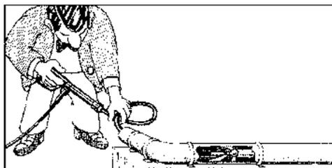
Чистка труб, каналов, стоков. Шланг для чистки труб с соплом KN и ниппелем ST 30 М 22 x 1,5.
