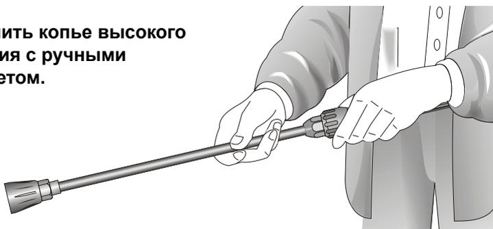
3. Шланг высокого давления размотать, не допуская образования петель, и соединить с ручным пистолетом и насосом. При удлинении использовать шланг высокого давления с макс. длиной 20 м или 2 x 10 м с шланговыми муфтами.
