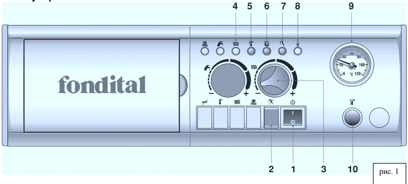
1 = Общий выключатель с сетевым индикатором (зел.)
