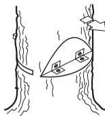
Возможность влияния на направление падения будет полностью утрачена, если полоса разлома слишком узкая или пропилована направляющий и основной пропилов плохо размещены.
