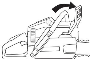
Зажигание; подсос: Установите рычаг подсоса в положение подсоса. Выключатель при этом должен автоматически перейти в положение пуска.
