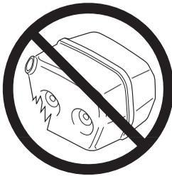
Периодически проверяйте, чтобы глушитель был надежно закреплен на корпусе машины.
