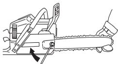
При установке новой цепи следует часто проверять ее натяжение, пока цепь не приработается. Регулярно проверяйте натяжение цепи. Правильно натянутая цепь обеспечивает высокое качество пиления и долгие служит.
