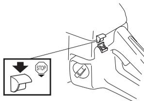
двигатель останавливается, когда контакт остановки будет передвинут в положение остановки.
