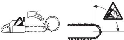
Резка нижней кромкой полотна, т.е. от поверхности объекта к нижнему краю известна как пиление с нажимом. В этом случае моторная пила сама наезжает на дерево и передний край моторной пилы соответствует естественному положению при резке. Пиление с нажимом обеспечивает
