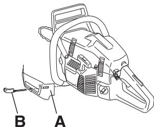
Они уменьшают доступ холодного воздуха и предохраняют от попадания большого количества снега в пространство карбюратора.
