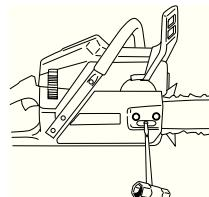
Цепь считается натянутой правильно, если она свободно проворачивается рукой. После этого, удерживая носок пильного полотна в вверхнем положении, затяните гайки крепления пильного полотна универсальным ключом.
