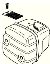
Глушитель служит для снижения уровня шума и отвода раскаленных выхлопных газов от рабочего. Выхлопные газы очень горячие и могут содержать искры, что может привести к пожару при прямом попадании на сухой и воспламеняющийся материал.
