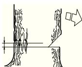
Вставьте зубчатый упор (если установлен), сзади надреза. Работайте на полном газу и вводите пильное полотно в ствол дерева постепенно, плавным движением. Следите за тем, чтобы дерево не начало перемещаться в направлении, противоположном предполагаемому направлению падения. Как только пропил станет достаточно глубоким, загоните в него клин или вагу.
