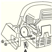
Установите пильное полотно на специально предназначенные болты. Установите полотно в самое заднее положение. Оденьте цепь на ведущую звездочку и вставьте ее хвостовики в паз пильного полотна. Начинайте с верхней стороны пильного полотна.
