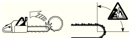
Отдача всегда происходит в плоскости резания пилы. Обычно при отдаче моторную пилу отбрасывает назад и вверх в направлении рабочего. Тем не менее моторная пила в момент отдачи может двигаться в различных направлениях в зависимости от метода резки, который применялся в момент касания зоны отдачи полотна и объекта.
