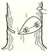
Возможность влияния на направление падения будет полностью утрачена, если полоса разлома слишком узкая или пропилована направляющий и основной пропилы плохо размещены.
