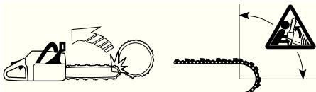
Резка нижней кромкой полотна, т.е. от поверхности объекта к нижнему краю известна как пиление с нажимом. В этом случае моторная пила сама наезжает на дерево и передний край моторной пилы соответствует естественному положению при резке. Пиление с нажимом обеспечивает лучший контроль над моторной пилой и расположением области отдачи.
