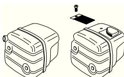
**Обратите внимание!** Глушитель при использовании сразу после остановки двигателя очень горячий. Это справедливо также при работе на холостых оборотах. Помните о риске пожара, в особенности при работе рядом с легко воспламеняемыми веществами и/или газами.
