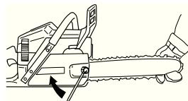
При установке новой цепи следует часто проверять ее натяжение, пока цепь не приработается. Регулярно проверяйте натяжение цепи. Регулярно проверяйте натяжение цепи. Правильно натянутая цепь обеспечивает высокое качество пиления и дольше служит.
