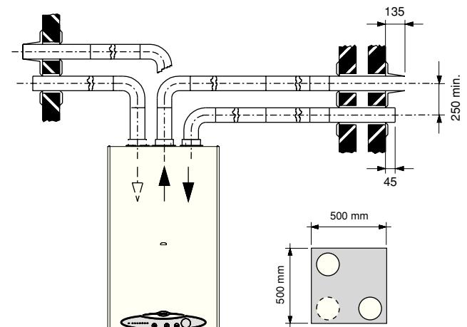
рис. 20 - Примеры установки с раздельными трубами
