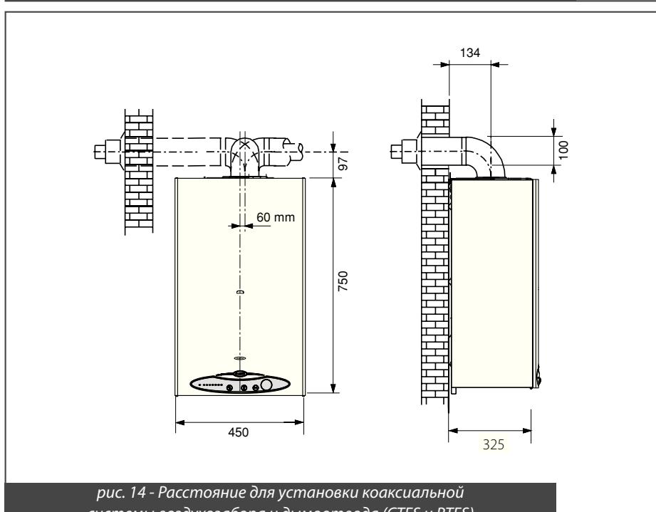
рис. 14 - Расстояние для установки коаксиальной системы воздухозабора и дымоотвода (CTES и RTES)
