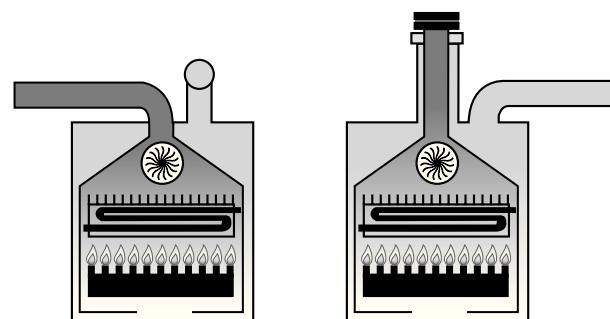
**C32** Конструкция котла предусматривает подключение к вертикальному терминалу осуществляющему воздухозабор и дымоотвод вне помещения с помощью коаксиальной или раздельной системы труб. Расстояние между каналами воздухозабора и дымоотвода должно составлять минимум 250 мм и оба выхода должны располагаться в пределах квадрата со стороной 500 мм.
