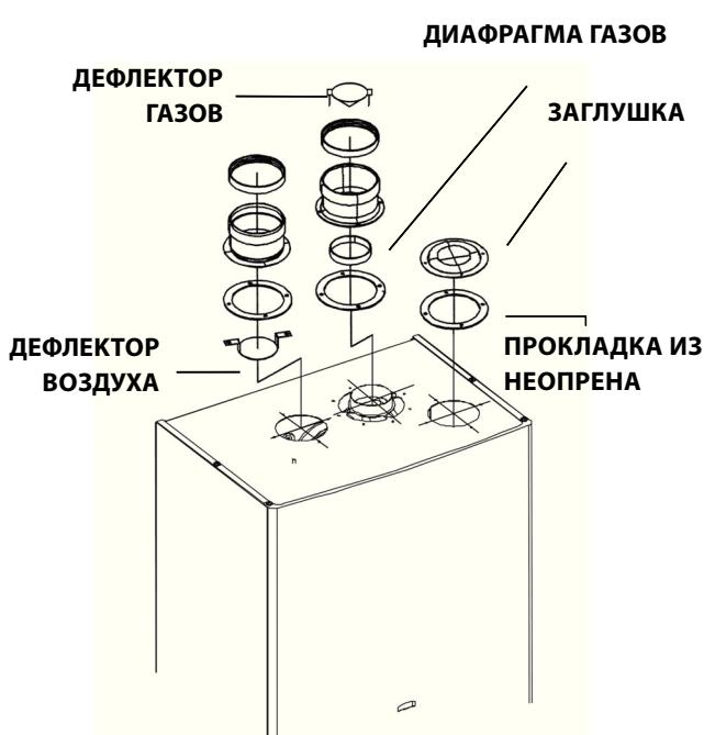
рис. 17 - Конфигурация воздухозабора и дымоотвода для установки с раздельными трубами (RTFS и CTFS)
