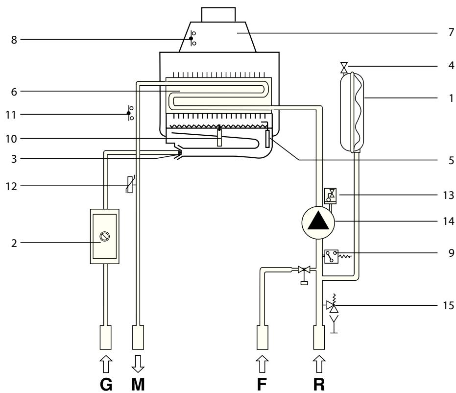
рис. 8 - Гидравлическая схема мод. RTN 24
