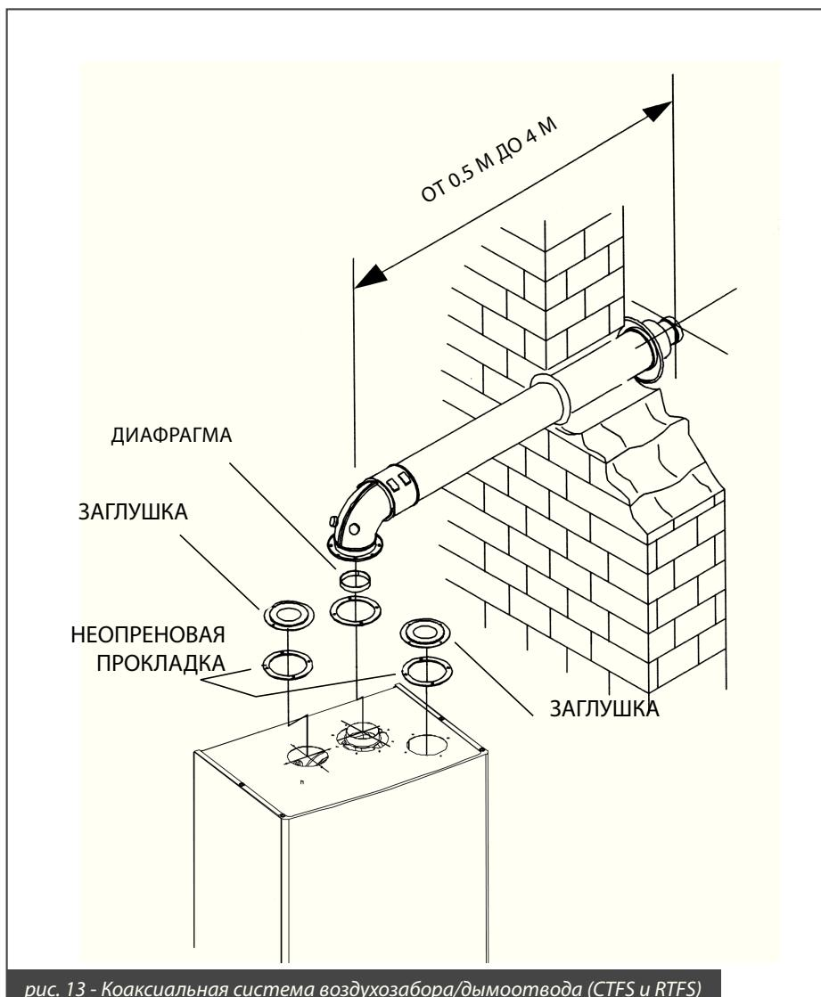
рис. 13 - Коаксиальная система воздухозабора/дымоотвода (CTFS и RTFS)
