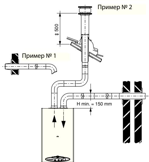
рис. 19 - Примеры установки с раздельными трубами
