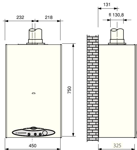
рис. 12 - Размеры для подсоединения дымоотводной трубы мод. CTN
