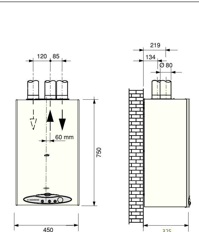
рис. 18 - Расстояние для установки раздельной системы воздухозабора и дымоотвода
