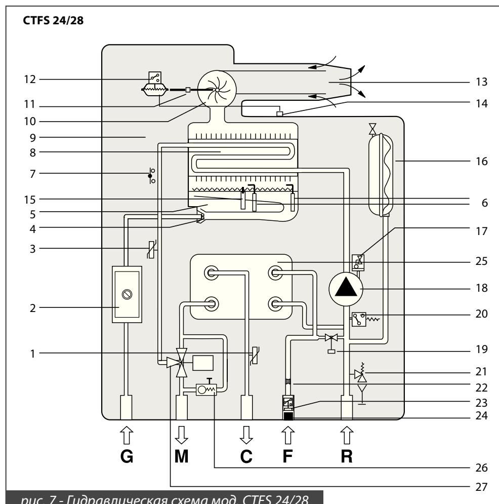
рис. 7 - Гидравлическая схема мод. CTFS 24/28
