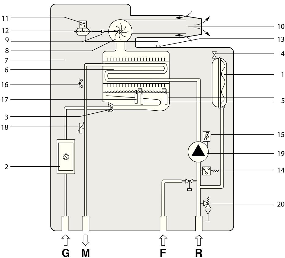
рис. 9 - Гидравлическая схема мод. RTFS 24/28
