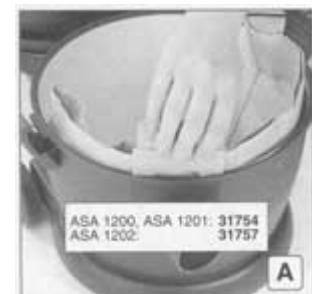
Бумажный фильтровальный мешок установить таким образом, чтобы он прилегал к стенкам бака, что предохранит его от повреждений при установки верхней части пылесоса. При отсасывании грубого материала и жидкостей бумажный фильтровальный мешок следует вынимать из бака.
