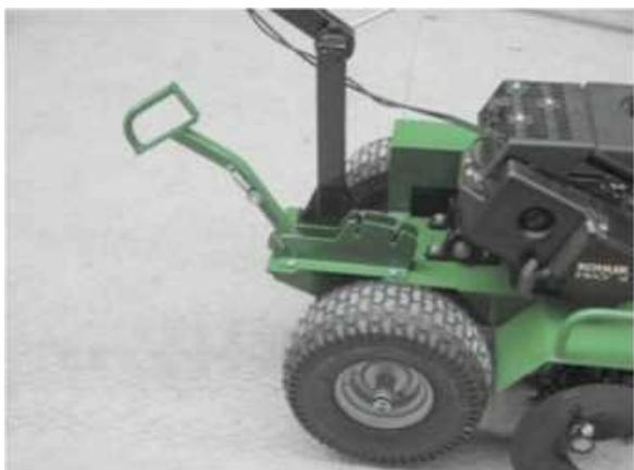
Установка рычага заглубления в положении DOWN
