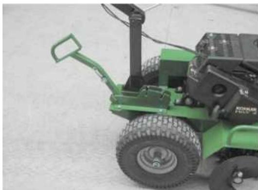
Установка рычага в положении UP
