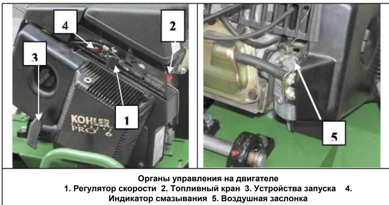
Если воздушная заслонка открыта в течение длительного промежутка времени после запуска, это может привести к “затоплению” карбюратора и остановке двигателя. Избыток топлива в камере сгорания увеличивает износ двигателя. Оставляйте заслонку открытой на время прогрева двигателя до его работы на холостом ходу. Не используйте воздушную заслонку в то время, когда работаете.
