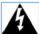
Предупреждает пользователя о наличии незащищенного «опасного напряжения» в определенных зонах оборудования, имеющего достаточную величину риска поражения электрическим током.
