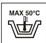
Обозначает максимально допустимую температуру моющего раствора. Расположен рядом с отверстием бака для моющего раствора.
