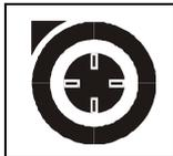
Обозначает всасывание. Сигнализирует о включении электродвигателя всасывания.
