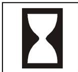
Обозначает счетчик моточасов.
