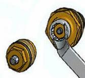
7.5. Притечии из-под штока регулировочного клапана, головка клапана может быть снята, отремонтирована или заменена. Головка отвинчивается с помощью гаечного ключа. Сливать воду из коллектора при этом не нужно.
