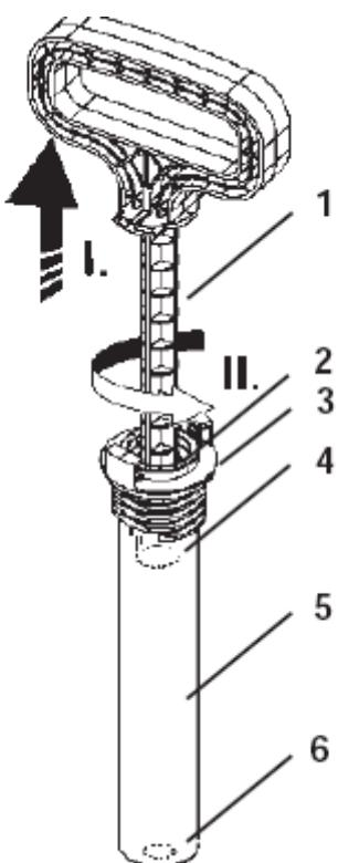
Для модели 462 насадка должна быть прикручиваться к распылительной трубке в красном фланцевом корпусе, пока она не защелкнется на место. Поместите нарезную муфту на трубку. Вдавите трубку полностью в соединительное звено, применяя сильное надавливание и поворачивая трубку. Вы укрепляете трубку закручиванием нарезной муфты. Для модели 461 трубка укрепляется на отсечном клапане таким же образом. Убедитесь, что вы полностью вдавили трубку перед тем, как укреплять ее нарезной муфтой.
