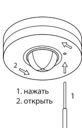
Рисунок 6. Схема монтажа датчиков ДДП-01, ДДП-02, ДДП-03, ДДП-04, ДДП-05
