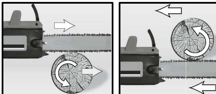
При неправильной распиловке древесины цепь может быть зажата бревном. Чтобы этого не произошло, определитесь, каким образом вы будете проводить распиловку древесины.
