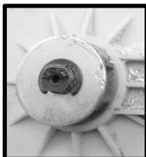
Ведущая звездочка подвержена особо высокой степени износа. Изношенная ведущая звездочка значительно сокращает срок службы пильной цепи. При глубине износа зубьев звездочки более 0,5 мм , ее необходимо заменить.
