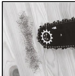
Найдите светлую поверхность, например, сруб дерева или доску. Направьте носок шины на светлую поверхность примерно в 20см от неё.
