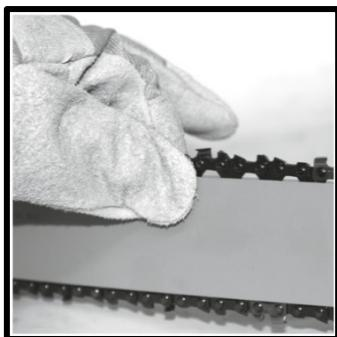
Возьмитесь за носок пильного полотна и поднимите его вверх, натягивая цепь. Хорошо затяните гайку пильного полотна универсальным ключом.
