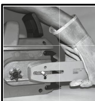
Наденьте шину длинным пазом на направляющую шпильку электропилы, при этом необходимо, чтобы натяжитель цепи совпал с отверстием для натяжения цепи нашине.
