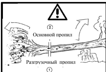
Толстый ствол с комлевой частью под напряжением.
