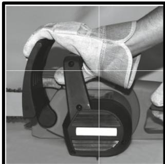
Установите тормоз цепи в нерабочее положение, сдвинув ручку тормоза в направлении передней ручки.
