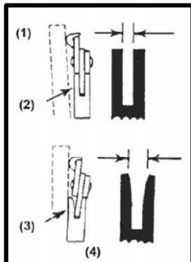
(1)-Линейка; (2)- Зазор; (3)- Нет зазора;
