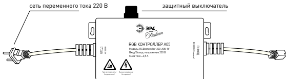
Рис.3. Подключение контроллера к источнику питания
