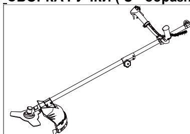
Возьмите ручку и установите её в специальную скобу для ручки. Установите скобу для ручки при помощи 4 крепёжных винтов, поставляемых в комплекте, и слегка их закрутите. Прикрепите ручку на шток в удобную рабочую позицию, затем туго затяните крепёжные винты.
