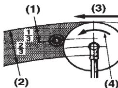
(4) Косите траву полосами шириной в 1,5 метра, поддерживая баланс устройства и прочность ступания. При использовании 3-х лопастного лезвия для покоса травы или кустарника всегда косите справа налево для того, чтобы оставлять скошенную траву слева для уборки.
