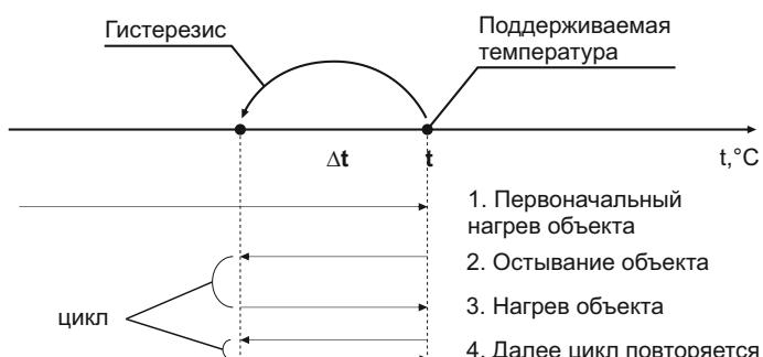
Гистерезис - это разница между температурой включения и отключения нагружки терморегулятора (падение температуры).
