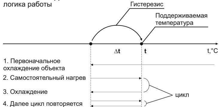
Гистерезис - это разница между температурой включения и отключения нагружки терморегулятора (падение температуры).
