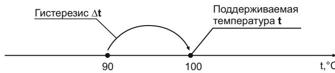
При этом охладительный элемент, управляемый терморегулятором, будет охлаждать объект до +90 °C и отключаться. После повышения температуры на 10°C, т.е. до 100 °C, терморегулятор снова включит охладительный элемент, начнется охлаждение и цикл повторится.
