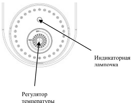
С помощью регулятора температуры установите необходимую вам температуру нагрева воды. Диапазон задания температуры от 25 до 75°C. Загорается индикатор работы, и водонагреватель начинает работать.
