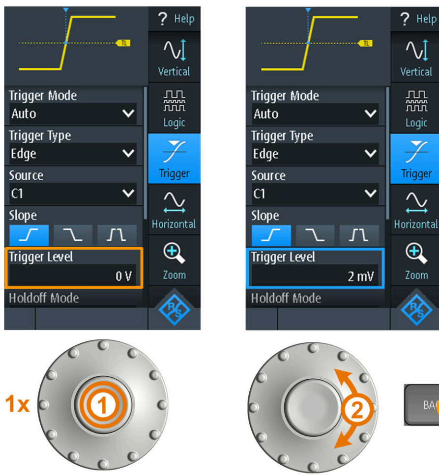
Рис. 4-6: Установите числовое значение с помощью колесика
