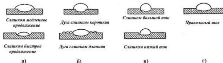
Рисунок 3. Типы сварочных швов.
