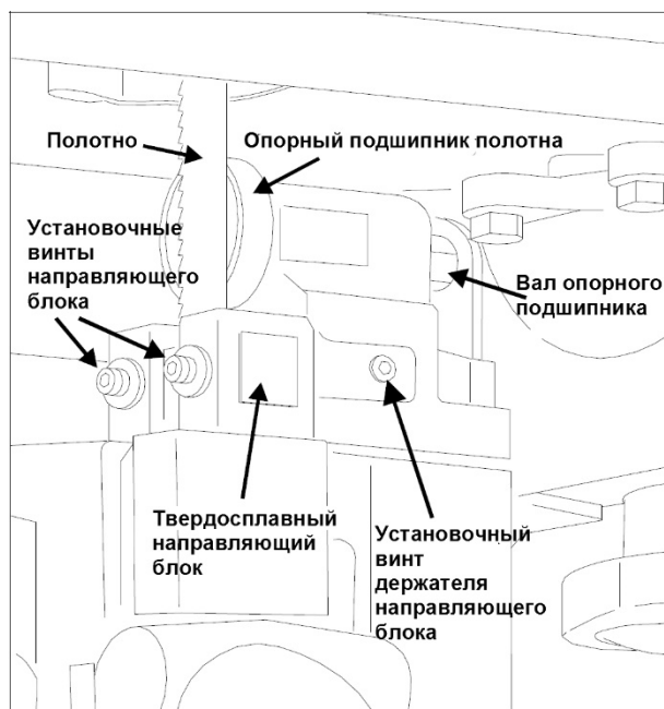
Рисунок 14. Нижний опорный узел полотна.
