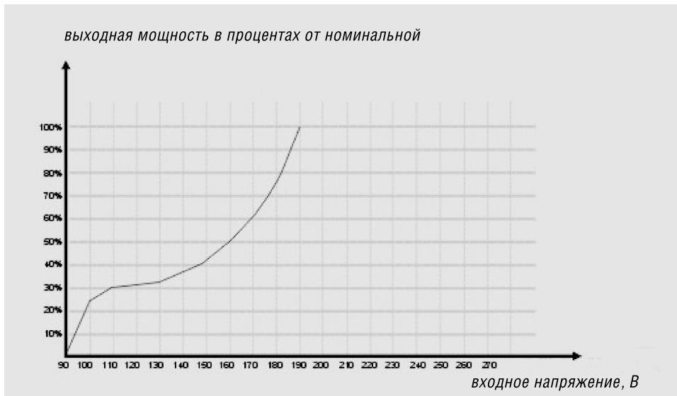
стабилизатор напряжения с запасом по мощности, полную суммарную мощность всех электроприборов необходимо умножить на 1,2–1,25.
