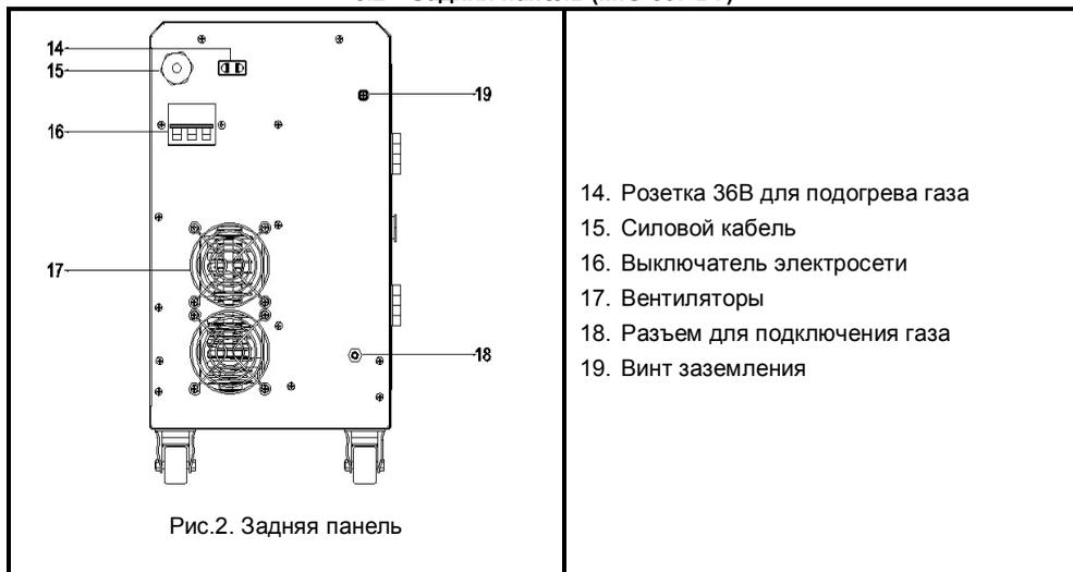
Рис.2. Задняя панель
