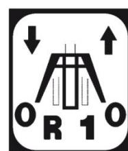
Включение задней скорости - R (модели с задним ходом)
