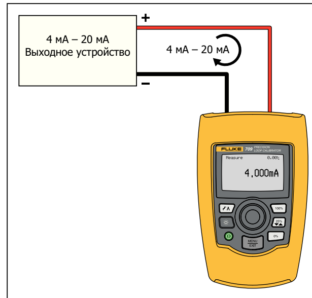
Рисунок 6. Соединения для измерения тока
