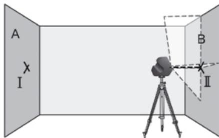
Поверните инструмент на 180°, не изменяя высоты. Направьте инструмент на стену А так, чтобы вертикальная лазерная линия проходила через уже отмеченную точку I. Выждать окончание компенсирования и пометить точку перекрещивания лазерных линий на стене А (точка III).
