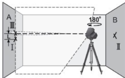
Разница L между обеими отмеченными точками I и III на стене А является действительным отклонением по высоте инструмента.
