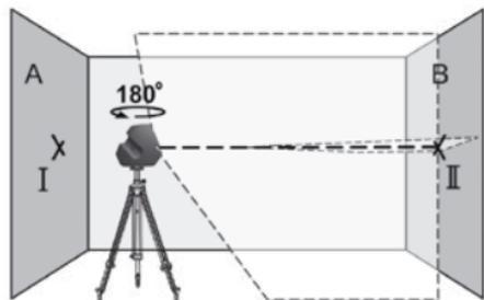
Установите инструмент, не поворачивая его, вблизи стены В, включите его и дайте ему время на компенсирование.
