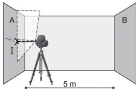
Поверните инструмент на 180°, дождитесь компенсирования и пометьте точку перекрещивания лазерных линий на противоположной стене В (точка II).
