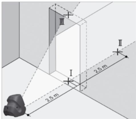
Отметьте середину вертикальной линии на полу проема двери (точка I), на расстоянии в 5 м с другой стороны проема двери (точка II), а также на верхнем крае проема двери (точка III).
