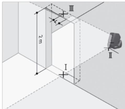
Разница  $L$  между точкой III и серединой лазерной линии на верхнем крае проема двери является действительным отклонением инструмента от вертикали.
