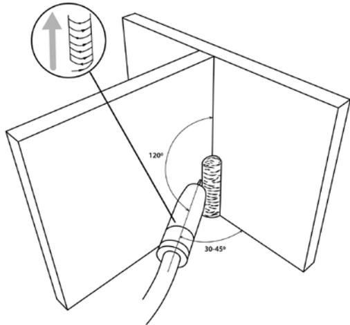
Угол наклона горелки при сварке тонколистового металла.
