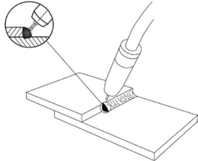
Слишком большой угол наклона горелки.
