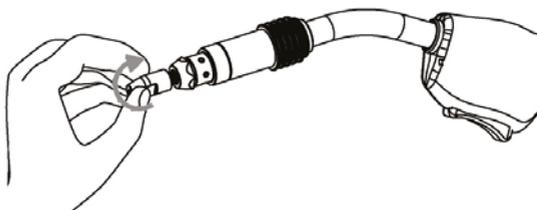
10. Закрутите прижимную гайку с помощью инструмента.
