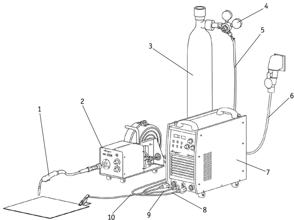
Рис. 8.2. Схема подключения оборудования при сварке порошковой проволокой.
