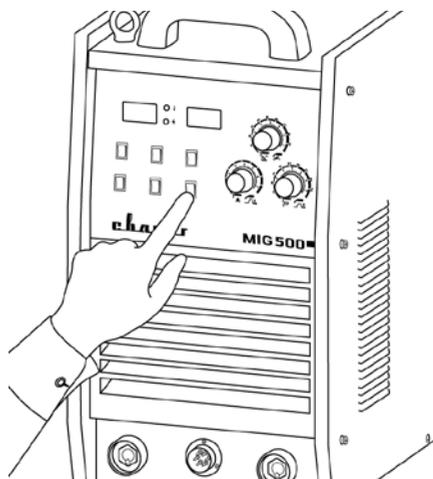
Рис. 8.22. Выбор диаметра сварочной проволоки
