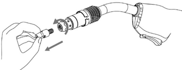
5. Нажмите и держите кнопку холостого прогона проволоки до тех пор, пока она не выйдет из горелки.
