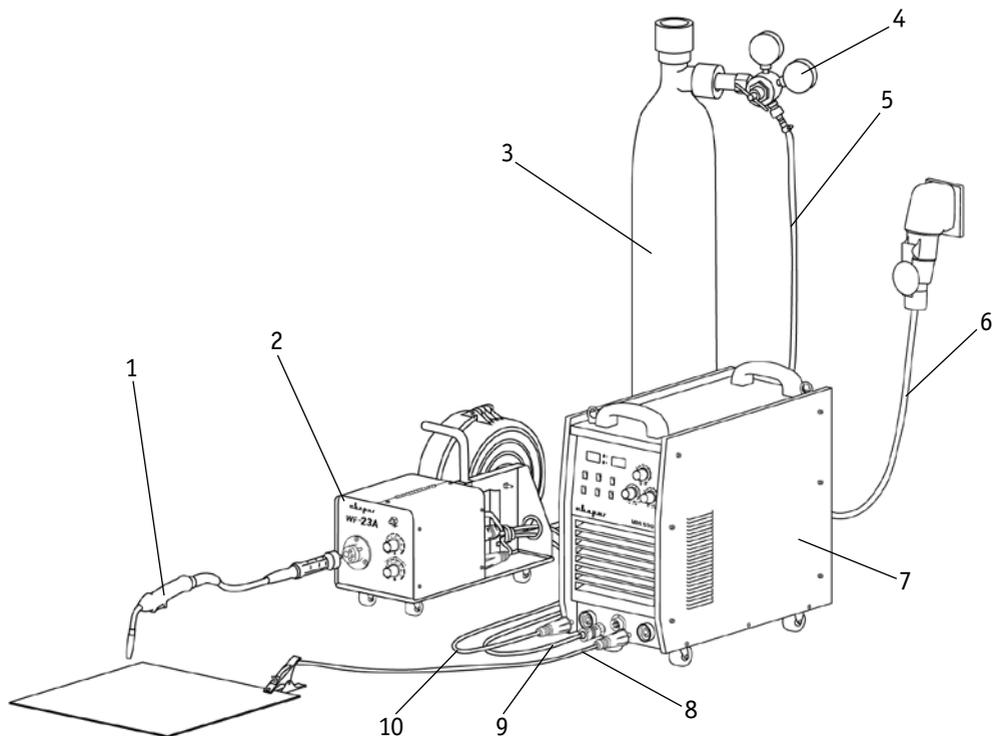
Рис. 8.1. Схема подключения оборудования при сварке сплошной проволокой.
